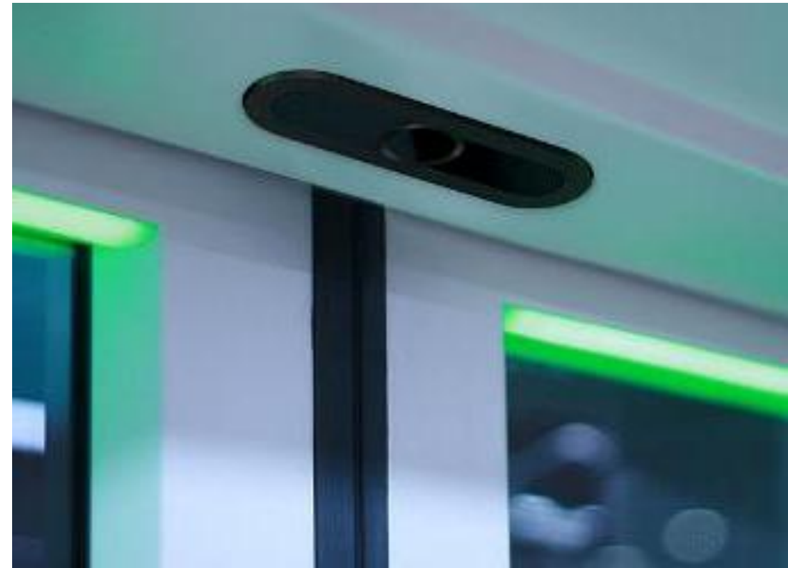
Czujnik serii IRMA w autobusie Solaris Urbino
